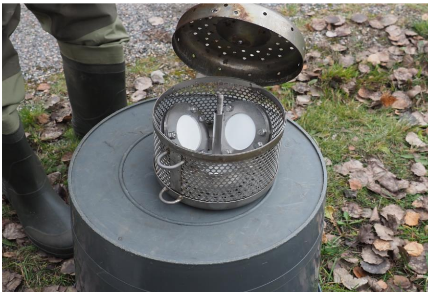
Kuva 4.1. POCIS-passiivikeräimien asennus altistushäkkiin (kuva: VHSVY).
