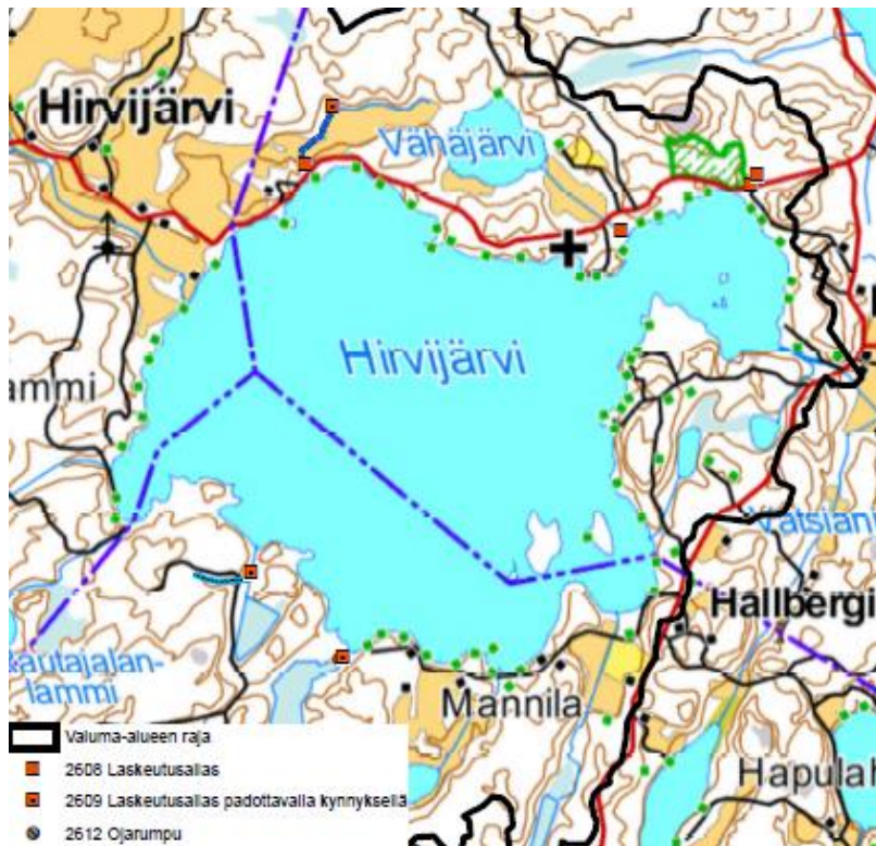
Kuva 20. Hirvijärven valuma-alueelle toteutetut vesiensuojelurakenteet.
