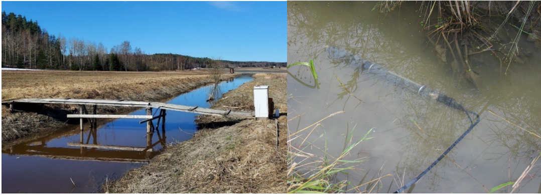
Kuva 3. Kipsin vaikutuksia Lepsämänjoen vedenlaatuun seurattiin valuma-alueen yläosiin asennetun vedenlaatuanturin avulla.
