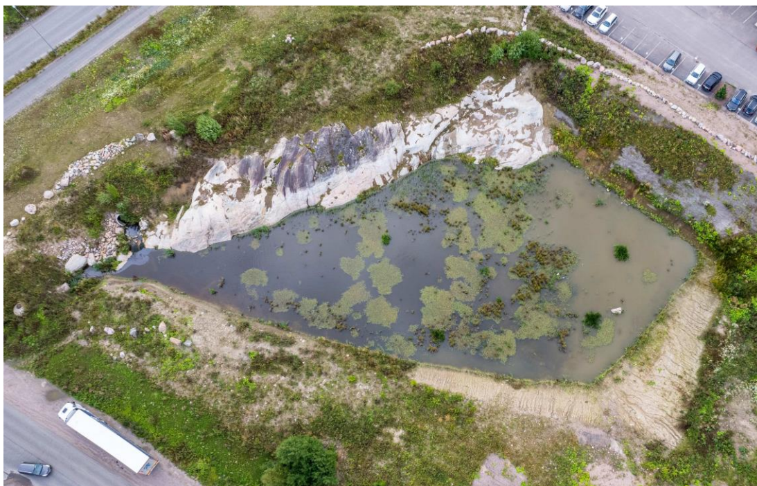
Kuva 23. Karhuntassuntien eteläinen hulevesialla. Jätehuoltoalueen hulevedet purkautuvat altaaseen luoteen suunnasta ja ne virtaavat altaasta pois heti lännen suuntaan (Kuva: 14.10.2024 VHVSY ry).
