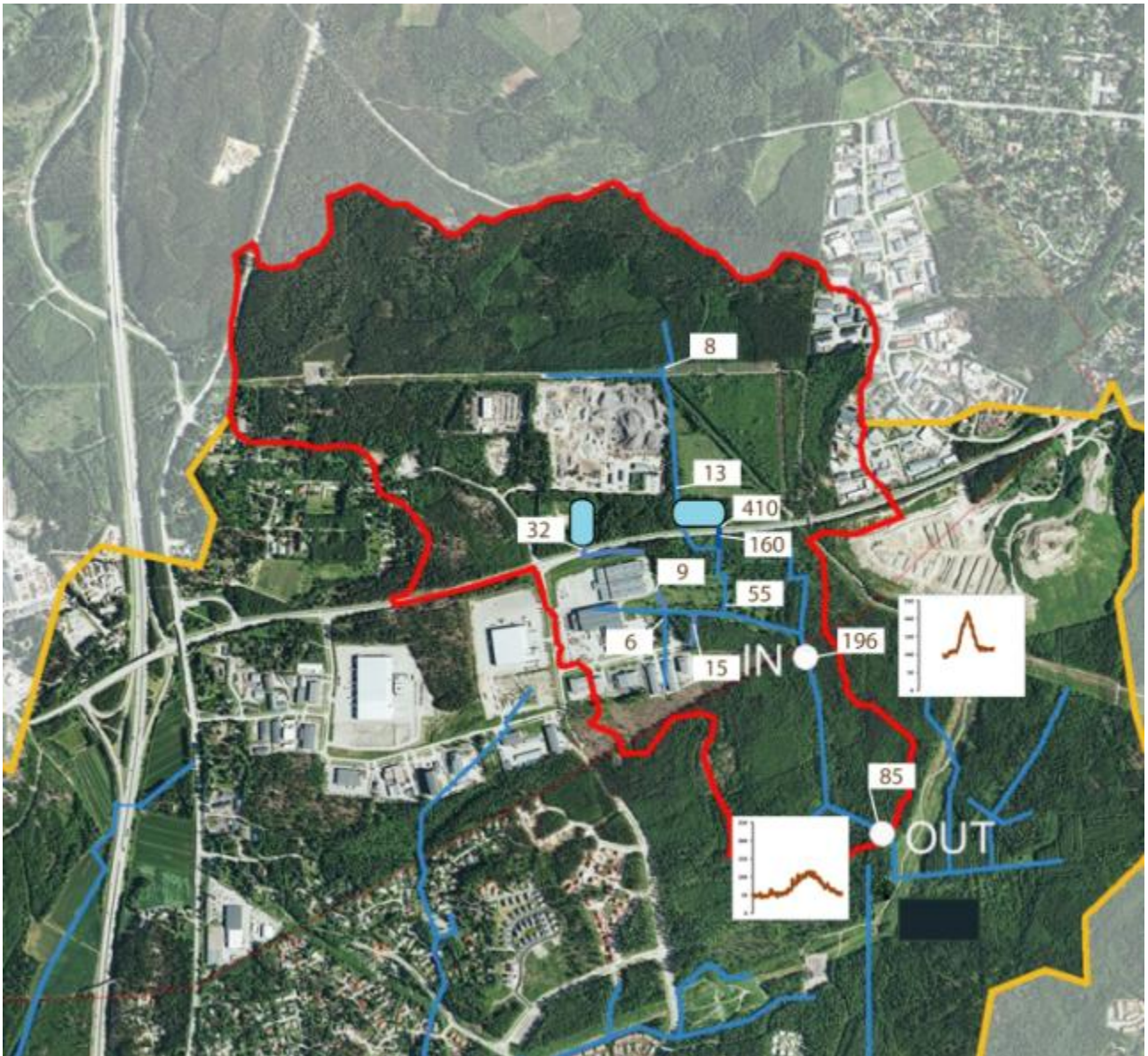
Kuva 11. Kylmäojan korven yläpuoliselta valuma-alueelta tehdyt sameusmittaukset osoittivat kiintoaineen alkuperäksi itäisen hulevesialtaan rakentamisesta johtuvan kaivamisen (ilmakuva ja valuma-aluearajaus, Vantaan kaupunki 2011).
