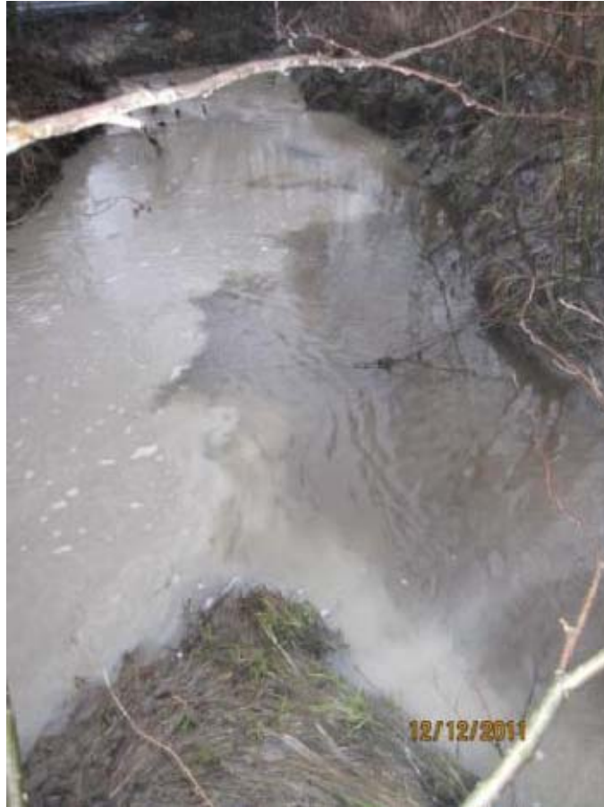
Kuva 27. Pyhtäänkorvenojan vesi sameni äkillisesti joulukuun 12. päivä. Oikealta siihen liittyy Kirkonkylänojan pääuoma. Pyhtäänkorvenojan sameus oli kuvanottohetkellä 35 kertaa (770/22 NTU) suurempi kuin pääuoman (kuva: Pasi Valkama 2011).
