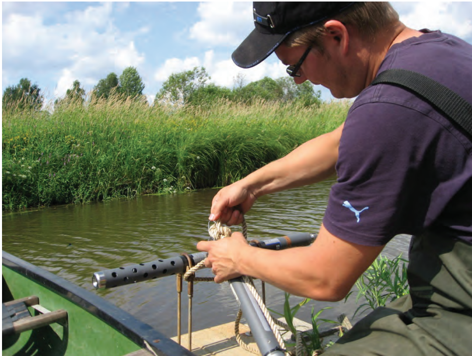
Kuva 8. Veden laadun mitta-antureiden asennusta Vantaanjoella Hyvinkäänylässä 22.7.2010 (kuva: Anna-Liisa Kivimäki, Vantaanjoen ja Helsingin seudun vesiensuojeluyhdistys ry, 2010).
