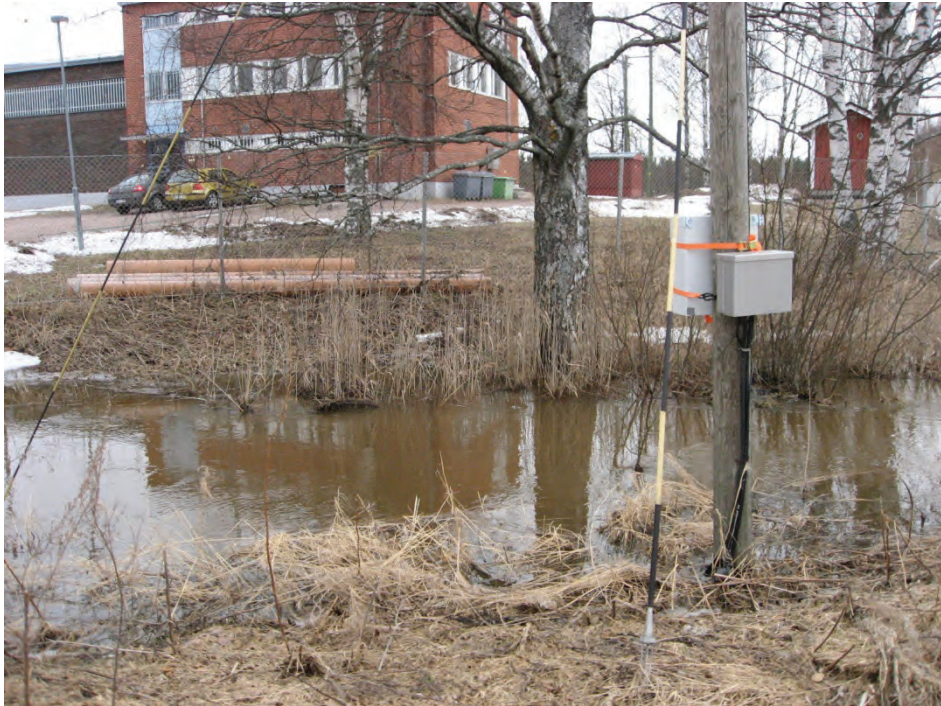
Kuva 10. Herajoen vedenottamon viereinen jokiveden pinnankorkeuden mittauspiste 11.4.2011. Herajoen ottamolla mitattiin paineanturilla jokiveden pinnankorkeutta sekä S::can-anturilla nitraattitypeä, liuennutta orgaanista hiiltä ja sameutta raakavedessä tunnin välein 31.3.–29.4.2011 (kuva: Anna-Liisa Kivimäki, Vantaanjoen ja Helsingin seudun vesiensuojeluyhdistys ry, 2011).
