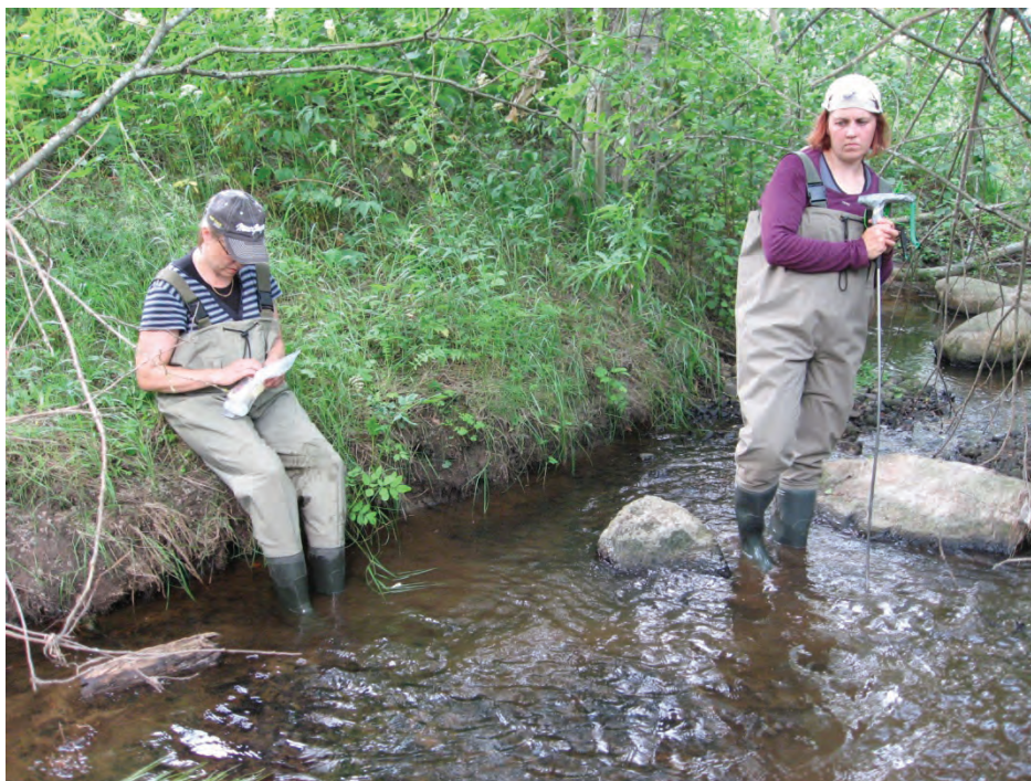
Kuva 7. Sedimentin lämpötilan mittausta Herajoella 14.7.2010 (kuva: Anna-Liisa Kivimäki, Vantaanjoen ja Helsingin seudun vesiensuojeluyhdistys ry, 2010).
