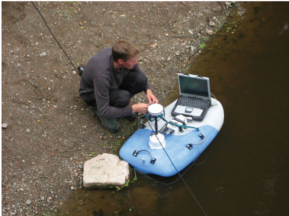
Kuva 15. Virtaamamittauksen valmistelua RiverSurveyor M9® -laitteistolla Vantaanjoella Hyvinkäänkylässä 24.7.2012 (kuva: Anna-Liisa Kivimäki, Vantaanjoen ja Helsingin seudun vesiensuojeluyhdistys ry, 2012).
