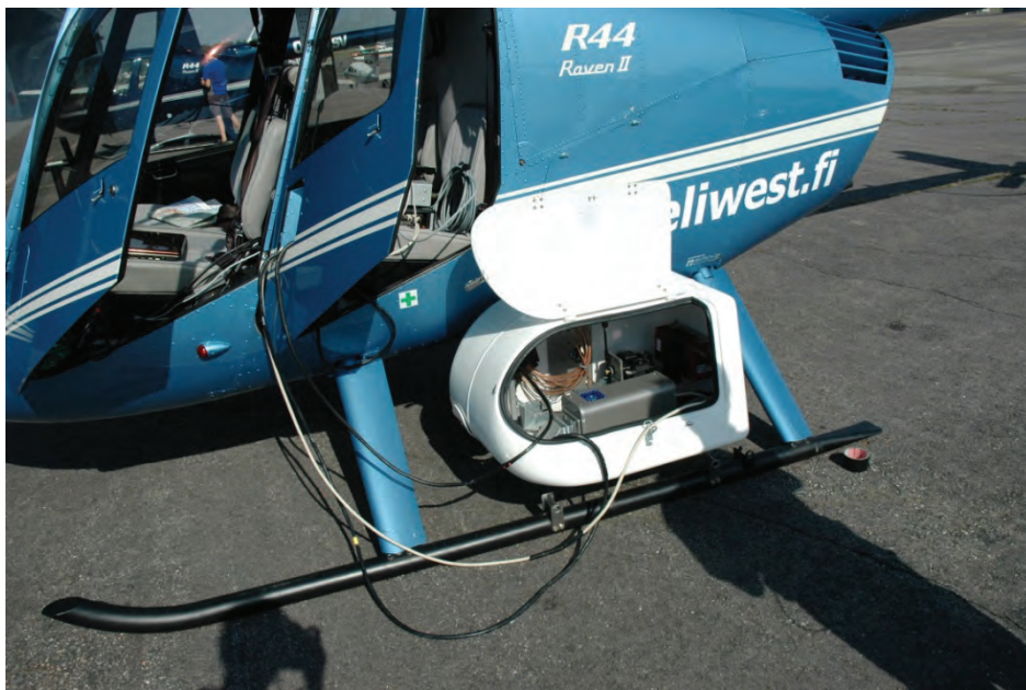
Kuva 2. Kuvauslaitteisto asennettuna helikopterin jalaksessa olevaan telineeseen (kuva: Tuuli Toivonen, Helsingin yliopisto, 2010).
