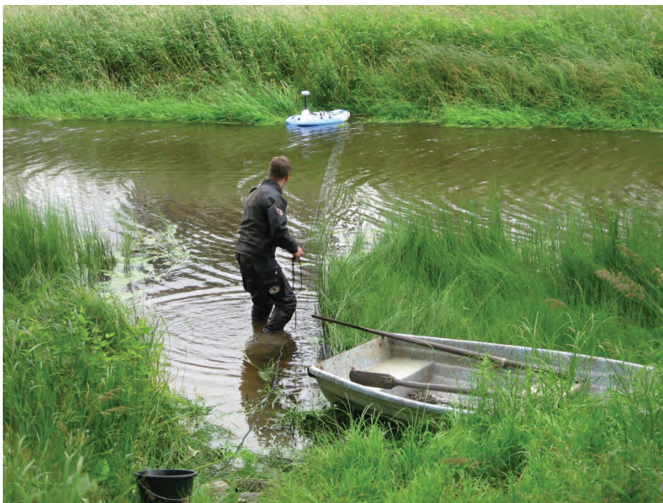
Kuva 16. Virtaamamittausta RiverSurveyor M9® -laitteistolla Vantaanjoella Hyvinkäänkylässä 24.7.2012 (kuva: Anna-Liisa Kivimäki, Vantaanjoen ja Helsingin seudun vesiensuojeluyhdistys ry, 2012).
