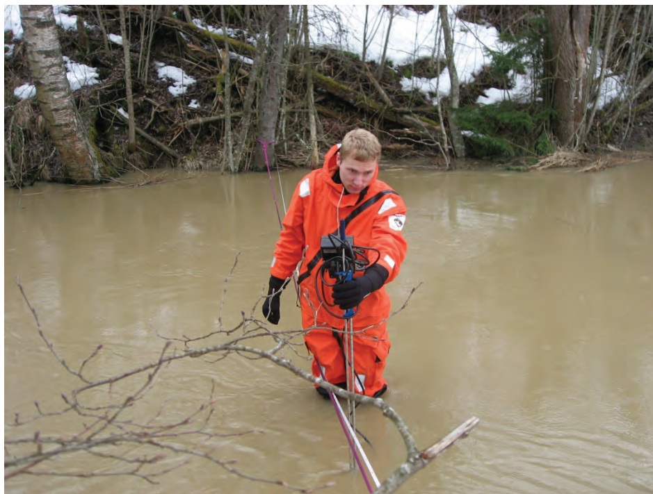
Kuva 14. Virtaamamittausta FlowTracker®-laitteistolla Palojoella Jäniksenlinnassa 13.4.2012 (kuva: Anna-Liisa Kivimäki, Vantaanjoen ja Helsingin seudun vesiensuojeluyhdistys ry, 2012).
