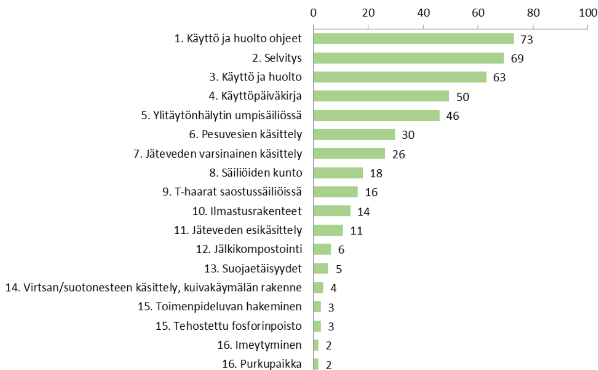
Kuva 7. Jätevesien käsittelyssä ja dokumentoinnissa havaittujen puutteiden yleisyys kiinteistöillä, joilla veden käyttö oli vähäistä suurempaa vuonna 2016 (n=111, vapaa-ajan asuntoja 12 %).
