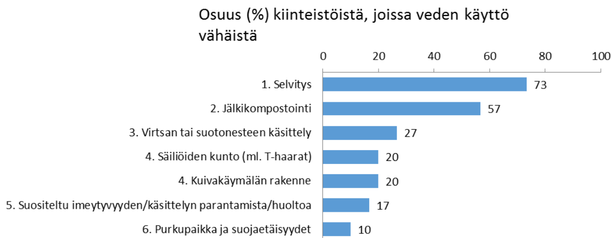
Kuva 8. Vähäisen vesimäärän kiinteistöillä havaittujen puutteiden yleisyys vuonna 2016 (n=30, vapaa-ajan asuntoja 93 %).
