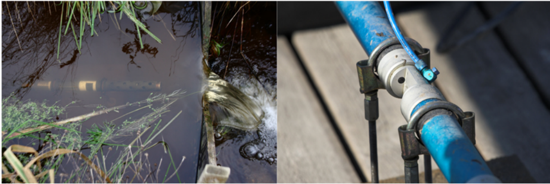
Kuva 2. Vasemmalla YSI:n johtokykyä, sameutta, pH:ta ja lämpötilaa mittaava anturi. Oikealla Scan Spectrolyser automaattisella paineilmapuhdistuksella varustettuna (kuvat Pasi Valkama).
