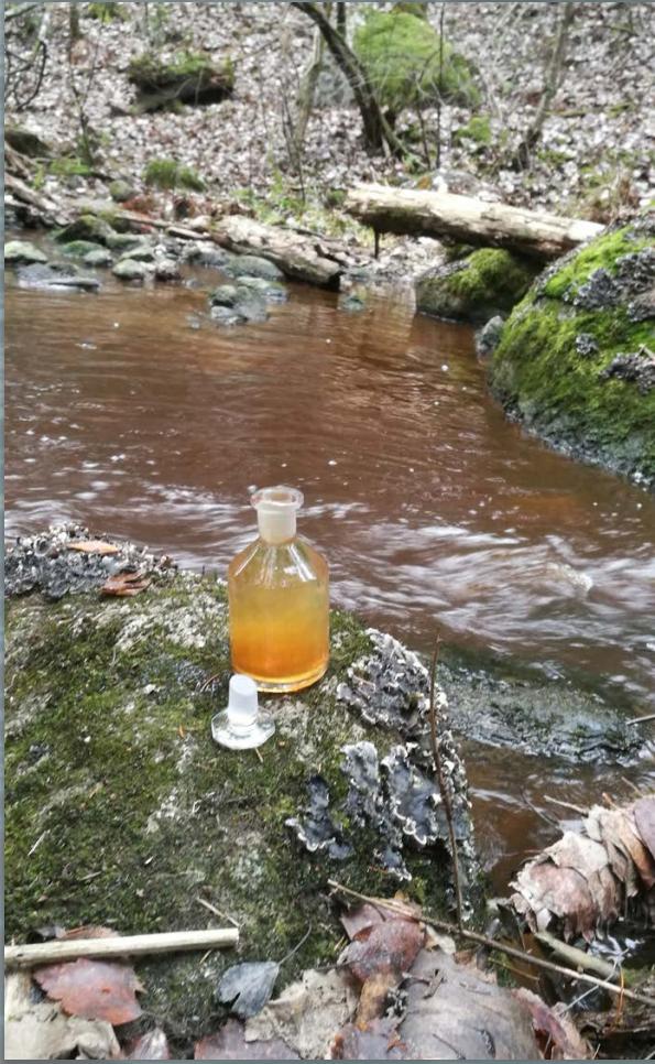
Kuvassa on happinäytepullo ja sen korkki. Pullon pohjalla näkyy saostunutta happea.
