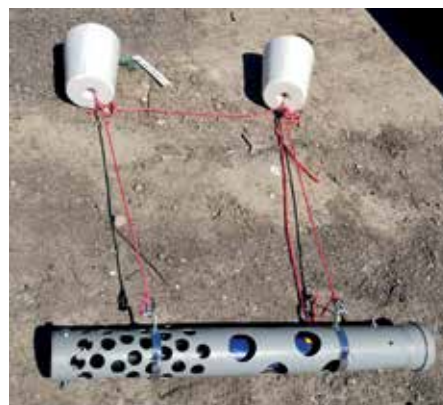
YSI:n EXO 3 -automaattimittari suojauputuksessa. Mittari poijutettiin kesällä 2019 kuudeksi viikoksi mittaamaan teollisuusjätevesien ylivuotoaltaaseen. Kuva LSVY.
