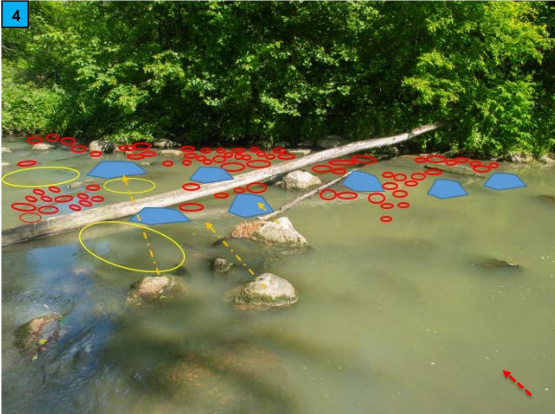
Kuva 4 Jokipuiston sillan alapuolinen alue. Alueen suurempia kiviä tulee siirtää ja kiviä lisätä siten, että osa virtauksesta ohjautuu kuvissa etuvasemmalle aukeavaan sivu-uomaan. Pääuoman laitoihin lisätään poikaskivikkoja (punaiset ympyrät), jotka toimivat taimenen pienpoikasten suojapaikkoina ja karikkeen pidättiminä. Samalla kivet kaventavat pääuomaa, jotta virtaus pääuomassa kiihtyy kutusoraikoille (keltaiset ympyrät) otollisemmaksi. Osa poikaskivestä tulee sijoittaa soraikkojen taakse, estämään soran huuhtoutuminen alavirtaan. Kuvissa näkyvää puunrunkoa ei tule poistaa uomasta. Runkoa voidaan käyttää virran ohjaamiseen ja soraikkojen tukena kivimateriaalin sijasta. Suurten kivien ja poikaskivien sijoittelut tulee tehdä ennen soran lisäämistä.
