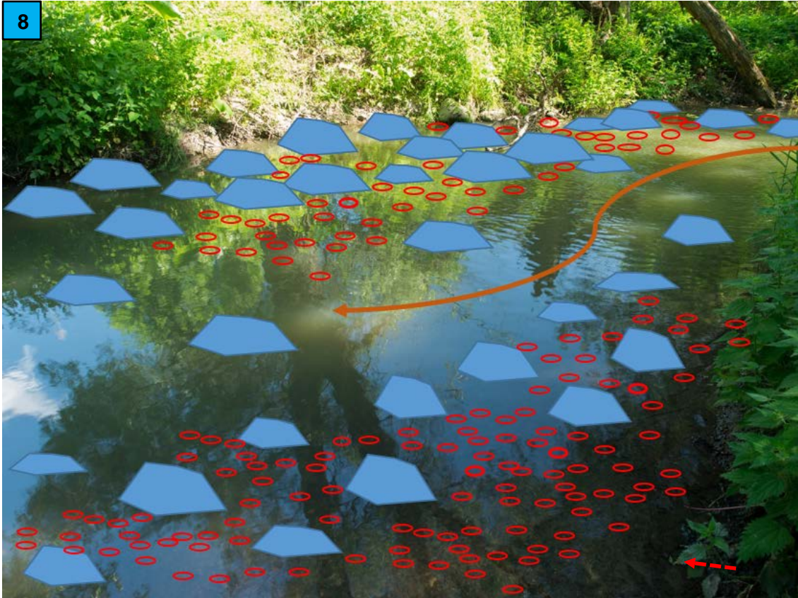
Kuva 8 Jokipuiston saaren sivu mutkan jälkeen alavirrasta kuvattuna. Alueen virtausnopeus on nykyisellään erittäin hidas ja joki on syönyt osan vastarannan penkasta. Tärkeimpänä kunnostustoimenpiteenä on suurempien viranohjauskivien (siniset monikulmiot) tuonti alueelle. Kivien avulla virtausta kiihdytetään ja käännetään kohti saartaa (tummanoranssi nuoli). Lisäksi virranohjauskivien sekaan tulee lisätä poikaskivikkoa. Kivikot toimivat kalojen elinympäristöinä, keräävät virran kuljettamaa lehtikariketta, joka toimii ravintona alueen hyönteisfaunalle.
