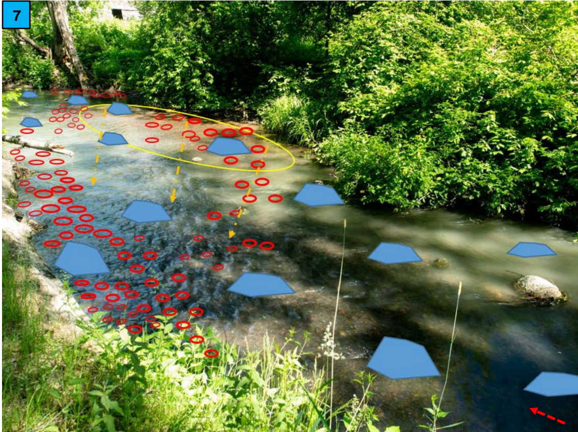
Kuva 7 Jokipuiston saaren sivun alin osuus hieman kuvan 5 ottopaikasta alavirtaan kuvattuna. Alueen tärkeimmät kunnostustoimenpiteet ovat virtauksen kiihdyttäminen ja monipuolistaminen, jotta koskialuetta saadaan jatkettua vasemmassa yläkulmassa näkyvään mutkaan asti. Virtausta kiihdyttämään ja monipuolistamaan alueelle lisätään virranohjaus- (siniset monikulmiot) ja poikaskivikkoja. Kuvan oikeassa ylälaidassa oleva soraikko tulee siirtää parempaan virtaukseen ja lisätä soran sekaan karkeampaa kutasoraa.
