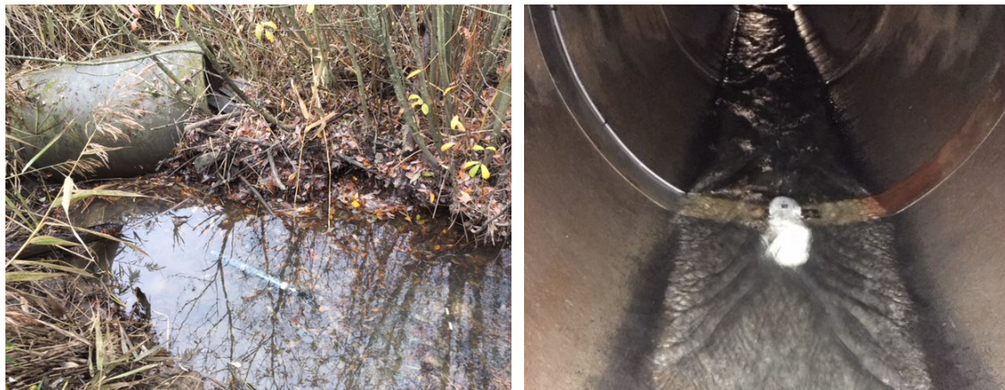
Kuva 2.4. Loutinojan Pajalan mittausaseman vedenlaatu (vasen) ja virtaama-anturit (oikea) sijaitsivat Piironpolun kohdalla. Kuvat: Luode Oy.
