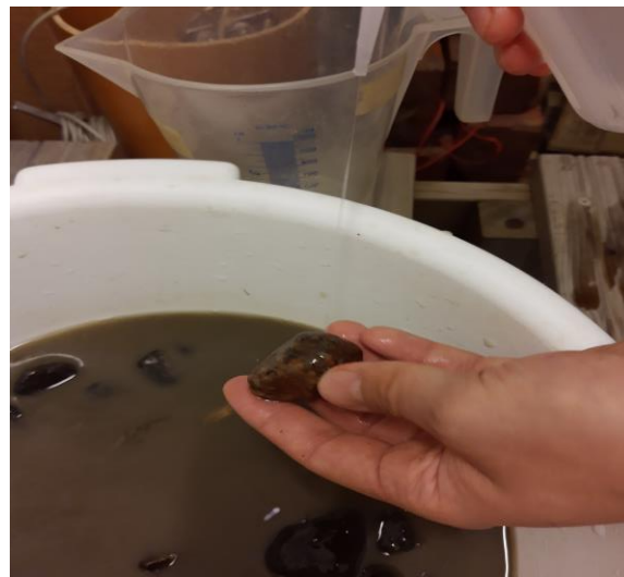
Kuva 25. Hienoaineksen huuhtelua irti sedimenttikeräimen sorasta.
