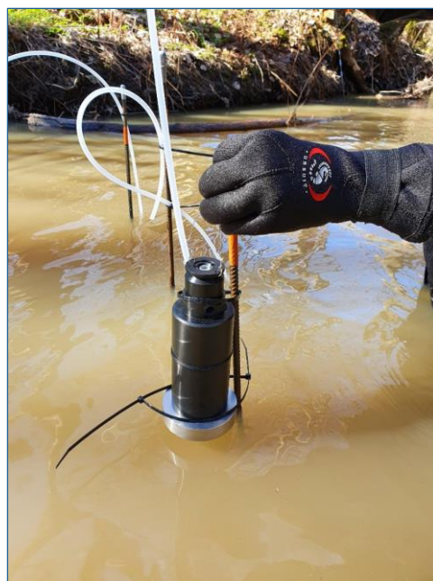
Kuva 17. Sorbicell-keräimen asennus vesisäiliöön kiinnitettynä pohjaveden havaintoputkeen (vasemmalla) ja jokiuoman pohjaan (oikealla) (kuvat Joonas Clergeaud).
