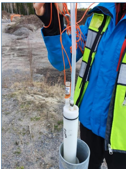
Kuva 17. Sorbicell-keräimen asennus vesisäiliöön kiinnitettynä pohjaveden havaintoputkeen (vasemmalla) ja jokiuoman pohjaan (oikealla) (kuvat Joonas Clergeaud).
