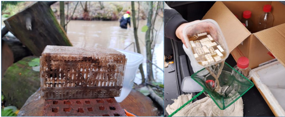
Kuva 20. Sedimenttikeräin altistusjakson jälkeen (vas.) ja kertyneen kiintoaineen siirtäminen näytepulloon (oik.)(kuva Oula Tolvanen).
