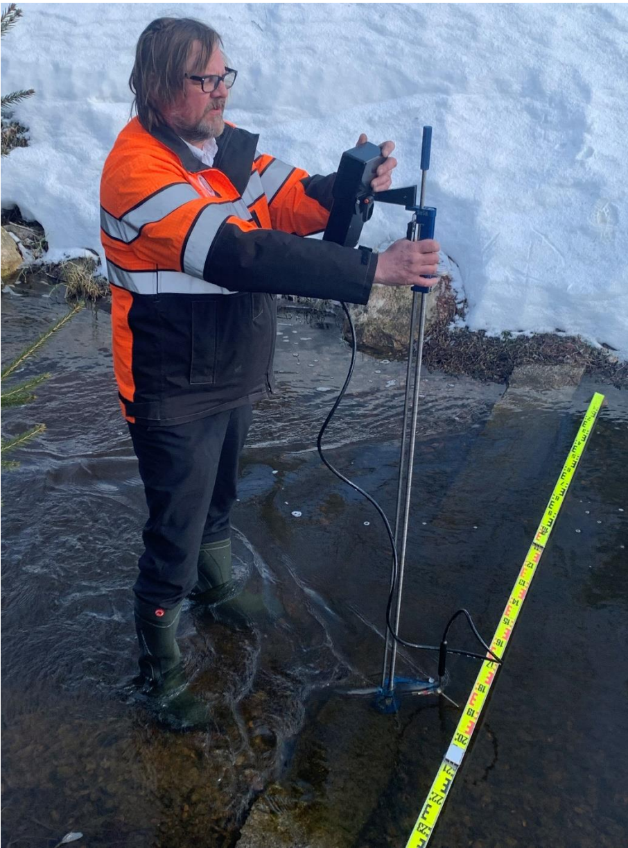
Virtaamamittausta FlowTracker -mittarilla
