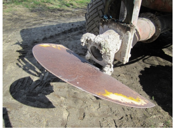
Kuva 9. Stabiloinnin aikana lietettä sekoitetaan, tarkistetaan pH ja stabiloitu liete levitetään pellolle traktorilla vedettävällä lietteenlevitysvaunulla (kuvat Teemu Haapala).
