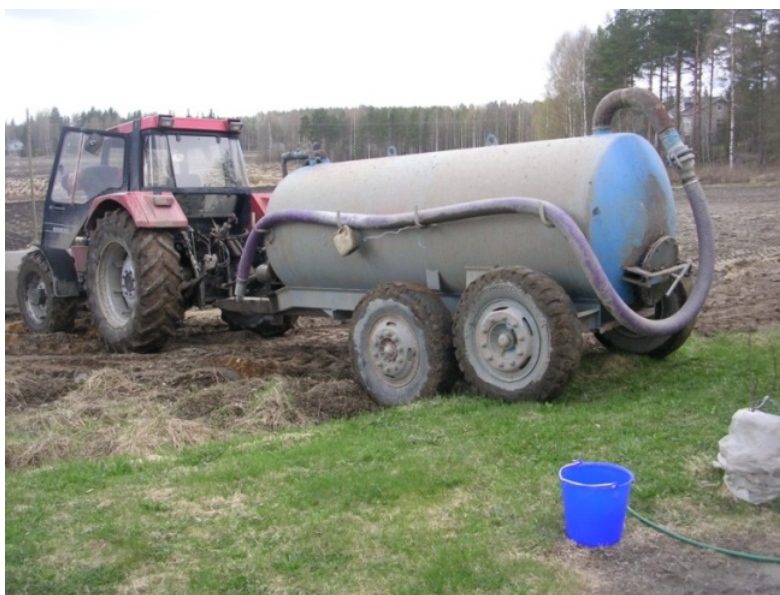
Kuva 3. Kalkkistabiloidun lietteen sekoitus ja levitys voidaan suorittaa imupainevaunun avulla (valokuva Päivi Jokinen).
