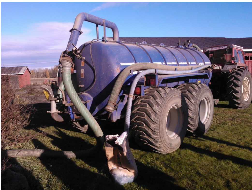
Kuva 7. Imupainevaunu on painesäiliö, mikä soveltuu maatilojen lietesäiliöiden ja kiinteistöjen likakaivojen tyhjennykseen. Imupainevaunussa säiliön täyttöön ja lietteen levitykseen tarvittava energia saadaan ilmakompressorista, joka kehittää joko yli- tai alipainetta (kuva Teemu Haapala).
