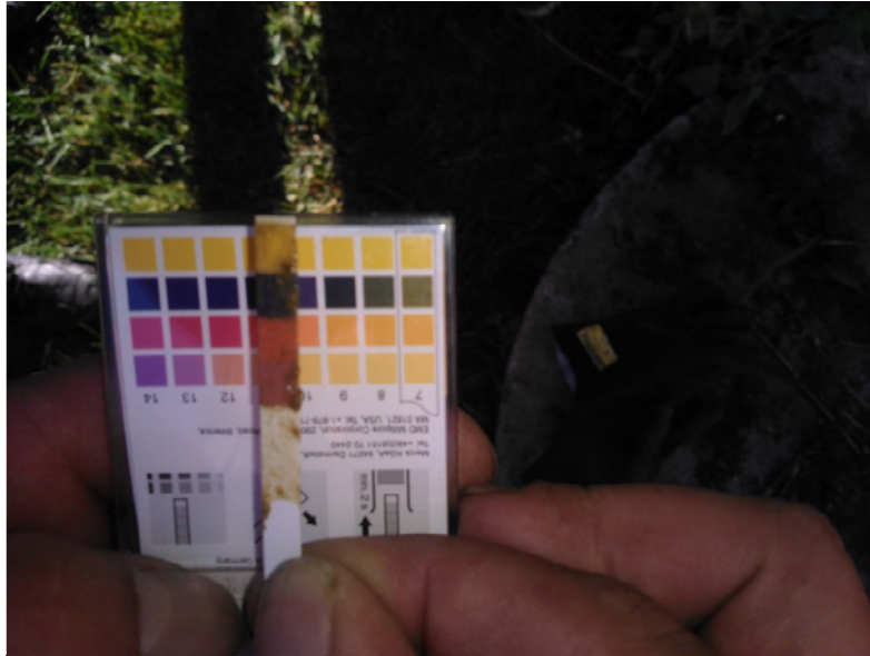
Kuva 8. Lietteiden pH tarkistetaan kalkkistabiloinnin jälkeen lakmus-paperilla vertaamalla sen värisarjaa kontrollitaulukkoon (kuva Teemu Haapala).
