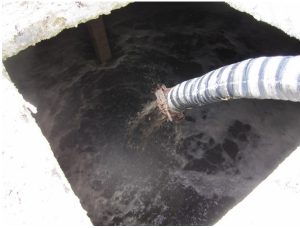
Kuva 9. Stabiloinnin aikana lietettä sekoitetaan, tarkistetaan pH ja stabiloitu liete levitetään pellolle traktorilla vedettävällä lietteenlevitysvaunulla (kuvat Teemu Haapala).
