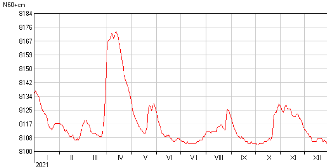
Kuva 3.38. Veden korkeus (N60) Ridasjärven pohjapadolla vuonna 2021. Kuva on Syke/Avointietorekisteristä tulostettu 20.4.2021. Rekisterissä olevat vedenkorkeustiedot ovat tarkistamattomia.
