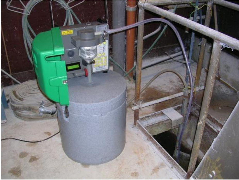
Kuva 6. Automaattinen vesinäytteenotin puhdistamolle tulevan jäteveden keräimenä.
