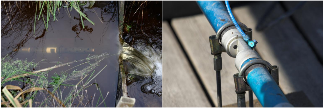
Kuva 4. Vasemmalla veden johtokykyä, sameutta, ja lämpötilaa mittaava anturi (YSI). Oikealla Scan Spectrolyser anturi automaattisella paineilmapuhdistuksella varustettuna.
